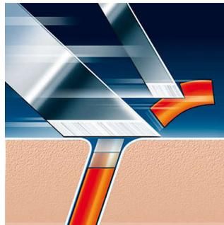
飛利浦電鬚刀的雙刀鋒系統：第一排刀鋒提起鬍鬚，第二排刀鋒舒適而乾淨地刮除鬍鬚。
