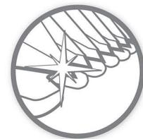
Há um contacto leve entre as lâminas em aço da máquina de barbear eléctrica que permite que estas se afiem mutuamente enquanto apara os pêlos! As lâminas ficam extremamente afiadas para cortar sempre os pêlos com precisão e eficiência, mas possuem pontas arredondadas para proteger a sua pele.
