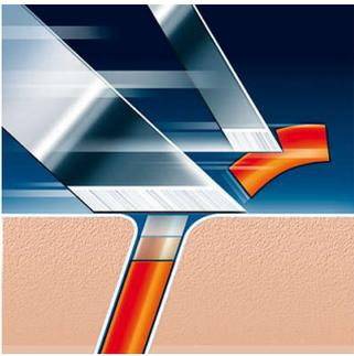
Sistema de doble cuchilla de la afeitadora Philips: la primera cuchilla levanta y la segunda corta, para conseguir un afeitado al ras y cómodo.
