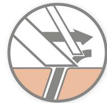
Das im Philips Elektrorasierer integrierte 2-Klingen-System hebt das Haar leicht an und schneidet es für eine gründliche Rasur direkt an der Hautoberfläche ab.
