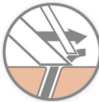
Das im Philips Elektrorasierer integrierte 2-Klingen-System hebt das Haar leicht an und schneidet es für eine gründliche Rasur direkt an der Hautoberfläche ab.
