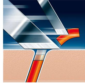
Sistema de doble cuchilla de la afeitadora Philips: la primera cuchilla levanta y la segunda corta, para conseguir un afeitado apurado y cómodo.
