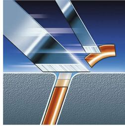
El sistema de doble cuchilla de esta afeitadora eléctrica levanta el vello y lo corta al ras.
