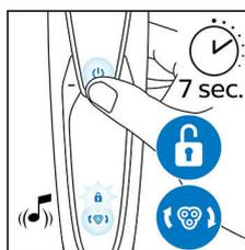
Индикатор замены выключится автоматически после 9 сеансов бритья. Вы также можете сбросить напоминание вручную после замены бритвенных головок, нажав и удерживая кнопку включения/выключения в течение не менее 7 секунд.
