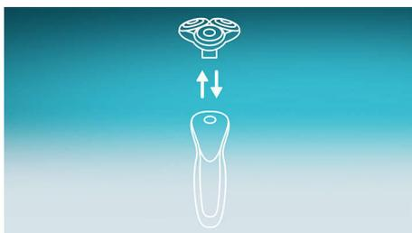
1. Снимите бритвенную головку. 2. Замените бритвенную головку на новую. 3. Чтобы сбросить параметры бритвы, нажмите и удерживайте кнопку включения/выключения в течение как минимум 5 секунд.
