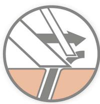
Sistem dva sečiva ugrađen u Philips električni aparat za brijanje podiže dlačice i prijatno ih seče ispod nivoa kože za glatke rezultate.
