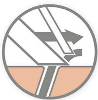
Sustav s dvije oštrice ugrađen u električni aparat za brijanje tvrtke Philips podiže dlačice kako bi ih nježno podrezao ispod razine kože i tako osigurao glatko brijanje.
