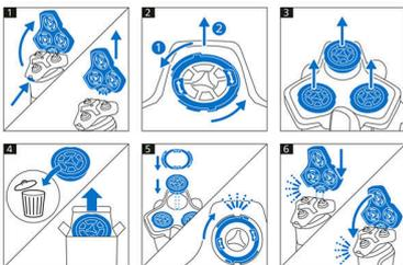
1. Premi i pulsanti di rilascio ed estrai il portatestina di rasatura. 2. Ruota gli anelli di supporto in senso antiorario e rimuovili. 3. Estrai
