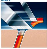
フィリップスシェーバーのダブルカッター内 刃:1 枚目の刃でヒゲを引き上げて2枚目の刃 が剃るため、肌にやさしい深剃りが可能です。
