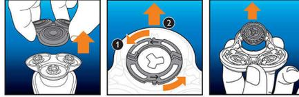
1. Apri il rasoio premendo il pulsante di sgancio; 2. Rimuovi il fermo ruotandolo in senso antiorario; 3. Estrai le testine di rasatura vecchie, inserisci quelle nuove e verifica che siano correttamente allineate; 4. Inserisci nuovamente il fermo e bloccalo ruotandolo in senso orario; 5. Quando la testina di rasatura è chiusa correttamente, sentirai un clic.
