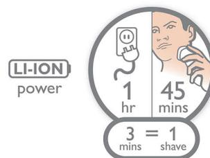
エネルギー効率が良くパワフルなりチウムイオンバッテリーにより、充電1回あたりのシェービング時間が長くなりました。1時間充電で約45分、つまり約15回シェービングできます。また、3分間の充電で約1回分のシェービングが可能です。
