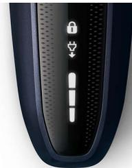
直观显示屏显示相关信息：- 3 格电池电量指示灯 - 清洁指示灯 - 电池电量不足指示灯 - 更换刀头指示灯 - 旅行锁指示灯
