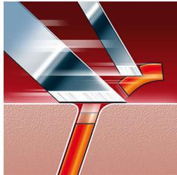
此款电动剃须刀的双层刀片系统可将须发提起，从肤下将须发舒服地剃掉。
