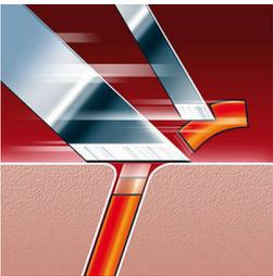
Sistem pisau ganda dari pencukur listrik ini mengangkat rambut untuk mencukurinya dengan aman di bawah lapisan kulit.
