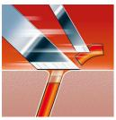
El sistema de doble cuchilla de esta afeitadora eléctrica levanta el pelo para cortarlo por debajo del nivel de la piel.
