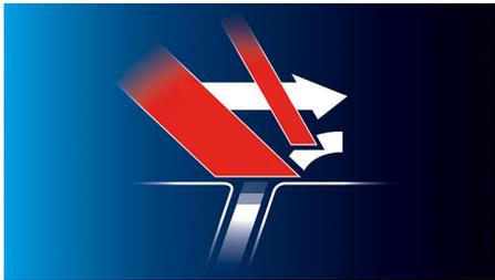
El sistema de doble cuchilla integrado en nuestras afeitadoras eléctricas levanta el pelo para cortarlo por debajo del nivel de la piel para un afeitado más apurado.
