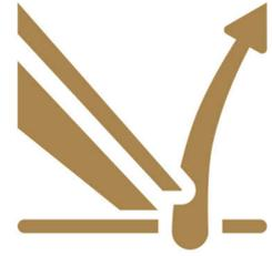
Le système à double lame du rasoir électrique Philips soulève les poils afin de les couper au plus près.
