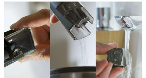
Détachez la tête de votre tondeuse à barbe Philips et rincez-la sous le robinet pour la nettoyer facilement. Séchez-la avant de la fixer à nouveau à l'appareil.
