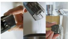
Détachez la tête de votre tondeuse à barbe Philips et rincez-la sous le robinet pour la nettoyer facilement. Séchez-la avant de la fixer à nouveau à l'appareil.
