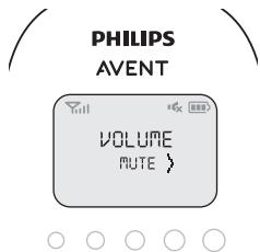
Na ekranu će se pojaviti poruka „MUTE“ (Isključen zvuk) i simbol isključenog zvuka. Samo će lampice za jačinu zvuka ukazivati na to da beba proizvodi zvuk.
