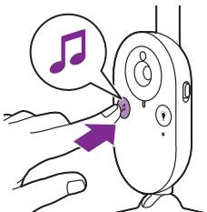
Da biste aktivirali funkciju uspavanke na jedinici za bebu, pritisnite dugme za uključivanje/isključivanje uspavanke na jedinici za bebu.
