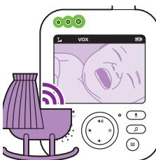
Ako beba plače, svetla za nivo zvuka će zasvetliti zeleno. Sve dok se zvuk ne detektuje, svetla za nivo zvuka su isključena.
