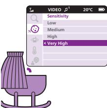
Ako vaša beba proizvodi samo tihe zvukove, osetljivost jedinice za bebu treba postaviti na visoki nivo osetljivosti na roditeljskoj jedinici.
