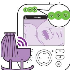
Kada jedinica za bebu uhvati neki zvuk, jedno ili više svetala za nivo zvuka na roditeljskoj jedinici zasvetle zeleno. Broj svetala koja će da zasvetle zavisi od glasnoće zvuka koju uhvati jedinica za bebu. Što glasnije beba plče, to će veći broj svetala za nivo zvuka zasvetliti zeleno.
