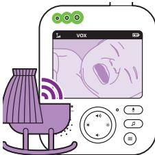
Kada jedinica za bebu otkrije zvuk, zaslon i zvuk roditeljske jedinice odmah se uključuju. Zvukovi se prenose roditeljskoj jedinici i indikatori razine zvuka zasvijetle zeleno. Sve dok nema nikakvog zvuka, indikatori razine zvuka bit će isključeni.
