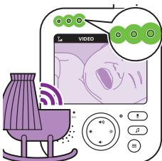
Kad jedinica za bebu otkrije zvuk, jedan ili više indikatora razine zvuka na roditeljskoj jedinici zasvijetlit će zeleno. Broj indikatora koji se uključuju ovisi o glasnoći zvuka koji je otkrila jedinica za bebu. Što glasnije dijete plaje, više indikatora za razinu zvuka zasvijetli zeleno.
