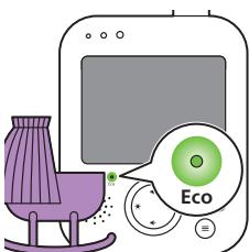
Kad je aktiviran način rada ECO, zaslon i zvuk roditeljske jedinice isključit će se ako se tijekom 20 sekundi ne otkrije zvuk. Indikator ECO zasvijetli zeleno kako bi se naznačilo da je aktiviran način rada ECO. Dok je uređaj u načinu rada ECO, prijenos prikaza i zvuka je isključen.
