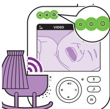
Körpə aparatı hər hansı səsi qəbul etdikdə körpə aparatının üzərindəki bir və ya bir neçə səs səviyyəsi işığı yaşıl rəngdə yanır. Yanan işıqların sayı körpə aparatının qəbul etdiyi səsin yüksəkliyindən asılıdır. Körpə nə qədər yüksək səslə ağlayarsa, o qədər çox səs səviyyəsi işığı yaşıl rəngdə yanır.
