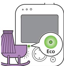
ECO rejimi aktivləşdirildikdə 20 saniyə ərzində heç bir səs aşkarlanmadığı halda, valideyn aparatının displayyi və səsi sönür. ECO rejiminin aktivləşdirildiyini göstərmək üçün ECO işığı yaşıl rəngdə yanır. ECO rejimdə display və səs ötürmələri sönülü olur.
