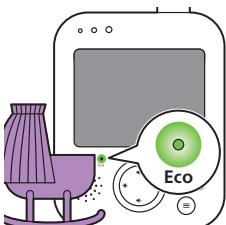
При активированном режиме ECO дисплей и звук родительского блока выключаются, если в течение 20 секунд не будет зафиксировано никаких звуков. Если индикатор ECO горит зеленым, значит, активирован режим ECO. В режиме ECO дисплей и передача звука выключены.
