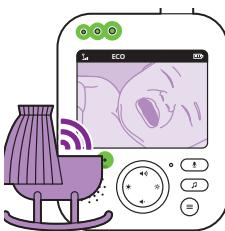
Körpə aparatı səs aşkarlaşıqda valideyn aparatının displayyi və səsi dərhal yanır. Səslər valideyn aparatına ötürülür və səs səviyyəsi işqları yaşıl rəngdə yanır. Heç bir səs aşkar edilmədiyi təqdirdə, səs səviyyəsi işqları sönülü olur.
