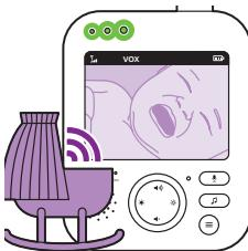
Körpə aparatı səs aşkarlaşıqda valideyn aparatının displayyi və səsi dərhal yanır. Səslər valideyn aparatına ötürülür və səs səviyyəsi işqları yaşıl rəngdə yanır. Heç bir səs aşkar edilmədiyi təqdirdə, səs səviyyəsi işqları sönülü olur.
