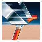
Sistema a doppia lama del tuo rasoio Philips: la prima lama solleva il pelo e la seconda lo taglia per una confortevole rasatura a fondo.
