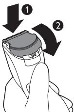
**2** 將新刀組的突耳插入導引槽 (1)，接著將刀組推回產品裝上 (2)。
