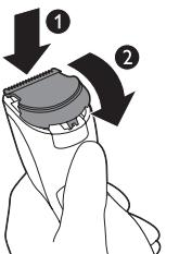
**2** 将新修剪部件的凸缘插入导向槽 (1) 内，然后将修剪部件推回产品 (2)。
