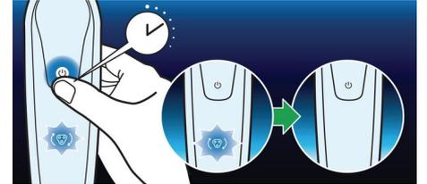
Les tout derniers rasoirs Philips incluent un rappel de remplacement qui vous indique quand les têtes de rasage doivent être changées. Après avoir remplacé celles-ci, vous pouvez réinitialiser la gâchette de remplacement en appuyant sur le bouton marche/arrêt pendant plus de 5 secondes. Dans le cas contraire, la gâchette de remplacement s'éteint automatiquement après 9 rasages successifs.
