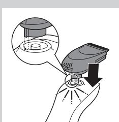
**3** 将胡须造型器附件的凸缘插入剃须刀顶部的槽内 (1)。然后按下胡须造型器附件 (2) 以将其安装在剃须刀上（可听到“咔哒”一声）。
