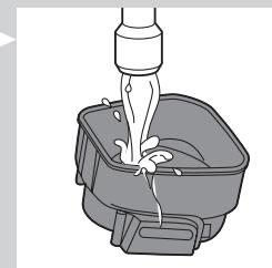
۴ محفظه تمیز کردن را با مایع تمیز کردن HQ200 تا سطح بین دو خط پر کنید.
