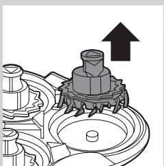
**4** 從電鬍刀刀網上取下刀片。
