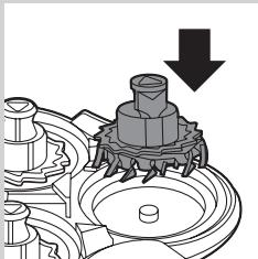
**7** 清洁后，将刀片重新装回至网罩，刀片底部朝下。
