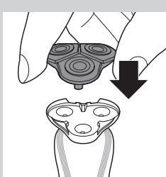
**10** 将剃须刀头支架重新装回剃须刀头部件的底部。
