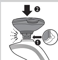
**7** 将剃须刀头部件的凸缘插入剃须刀顶部的槽内 (1)。然后按下剃须刀头部件 (2) 以将其安装在剃须刀上（可听到“咔哒”一声）。
