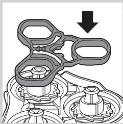
**8** 將固定架裝回電鬍刀刀頭固定座。
