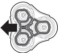
2 按固定架所示的箭头方向滑动绿色固定架。
