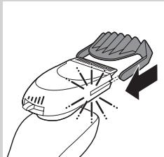
**1** 将修剪梳直接滑入胡须造型器附件两侧的导槽中（可听到“咔哒”一声）。
