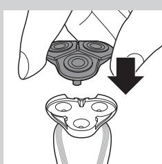
**3** 将剃须刀头支架抽离剃须刀头部件的底部，然后在热水龙头下冲洗 30 秒。
