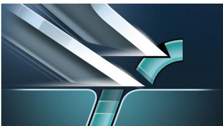
Das im Philips Elektrorasierer integrierte 2-Klingen-System hebt das Haar leicht an und schneidet es für eine gründliche Rasur direkt an der Hautoberfläche ab.
