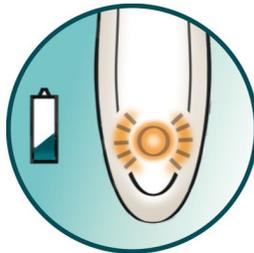
Indica un nivel bajo de la batería y recuerda cargar el aparato antes de la siguiente depilación
