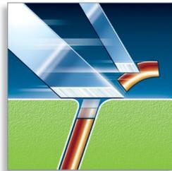
Système à deux lames : la première lame soulève le poil, la seconde le coupe. Résultat : un rasage agréable, d'une précision exceptionnelle.
