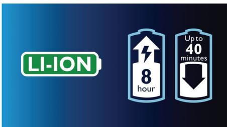
La batterie lithium-ion puissante et efficace vous offre un plus grand nombre de rasages par charge. L'autonomie est de 40 minutes, soit 14 rasages environ, pour 8 heures de charge. En branchant l'appareil sur le secteur pendant 3 minutes, vous aurez suffisamment d'autonomie pour un rasage.
