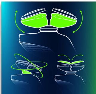
Los cabezales de seguimiento de los contornos GyroFlex 3D se ajustan perfectamente a cada curva de la cara, minimizando la presión y la irritación.
