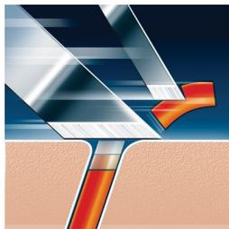
Sistema a doppia lama: la prima lama solleva il pelo e la seconda lo taglia per una confortevole rasatura a fondo.
