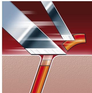
Le système à double lames redresse les poils pour un rasage de près et confortable.
