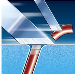
Sistema de doble cuchilla: la primera cuchilla levanta y la segunda corta, para conseguir un afeitado apurado y cómodo.
