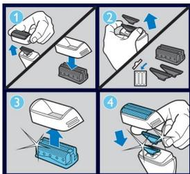
1. отсоедините насадку бритвы с устройства Styleshaver. 2. Снимите старую сетку и режущие блоки. 3. Поместите новую сетку в держатель. 4.
