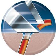
Der Philips Rasierer verfügt über ultradünne Scherköpfe mit Schlitzern zum Erfassen langer Haare und Löchern, mit denen auch kürzeste Bartstoppeln erfasst werden können.
