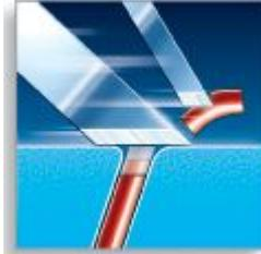
El sistema de doble cuchilla de esta afeitadora eléctrica levanta el pelo para cortarlo por debajo del nivel de la piel.
