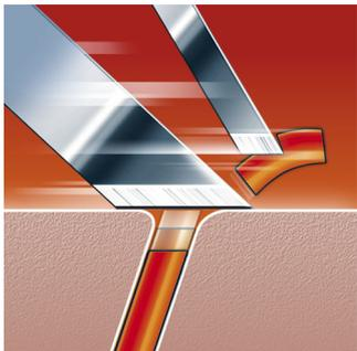
Das 2-Klingen-System hebt das Haar leicht an und schneidet es an der Hautoberfläche ab.
