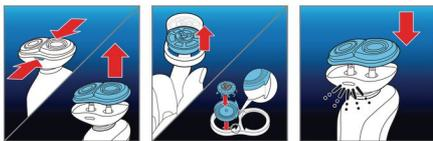
1. Drücken Sie die Entriegelungstasten auf der Schereinheit, und ziehen Sie den Scherkopfhalter von der Schereinheit ab. 2. Drehen Sie die Halteringe gegen den
