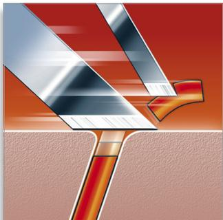
O sistema duplo de lâminas levanta os pelos para cortá-los confortavelmente no nível da pele.
