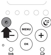
No modo de atenuação noturna da luz, a intensidade das luzes e do visor é reduzida e o volume dos sons de alerta é diminuído.
