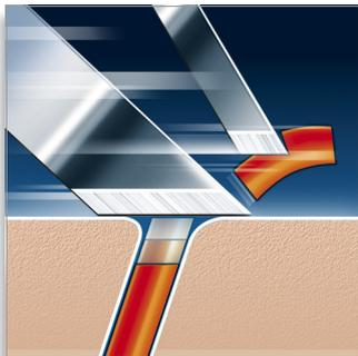
Sistema de duas lâminas: a primeira levanta o pêlo e a segunda corta, proporcionando um barbear rente e confortável.
