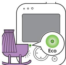
Quando o modo ECO é ativado, o visor e o som da unidade dos pais desligam-se, se não for detetado som durante 20 segundos. A luz ECO acende-se a verde para indicar que o modo ECO está ativado. Durante o modo ECO, as transmissões do visor e do som são desligadas.
