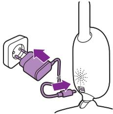
Coloque o adaptador de corrente na unidade do bebé e ligue o adaptador à tomada elétrica.
