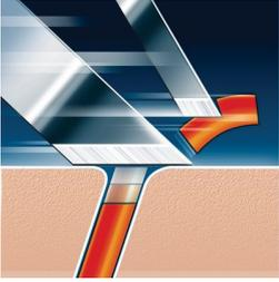
フィリップスシェーバーのダブルカッター内刃：1枚目の刃でヒゲを引き上げて2枚目の刃が剃るため、肌にやさしい深剃りが可能です。
