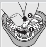
**4** Αφαιρέστε τις ξυριστικές κεφαλές και τοποθετήστε καινούριες κεφαλές στη μονάδα ξυρίσματος.
