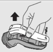
Nach Entnahme des Akkus darf das Gerät nicht mehr am Netz betrieben werden.
