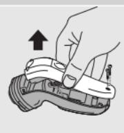
بگذارید که دستگاه تا هنگام متوقف شدن کار کند، پیچها را شل کنید و ریش تراش را باز کنید.
