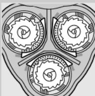
Assicurarsi che le sporgenze delle testine di rasatura si inseriscano perfettamente nelle rientranze.
