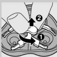
**1** Ouvrez l'unité de rasage, tournez la molette dans le sens inverse des aiguilles d'une montre (1) et retirez la plaque de fermeture (2).
