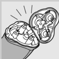
**5** Abra novamente a unidade de corte e deixe-a aberta para permitir que a máquina seque completamente.
