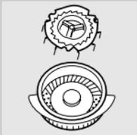
**2** Fırça ile kesici ve koruyucu parçaları temizleyin.
