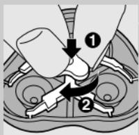
**5** Rimettete il telaietto di fissaggio nell'unità di rasatura, premete la rotella (1) e ruotatela in senso orario (2).
