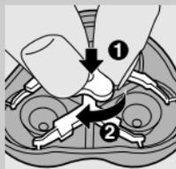
**5** Remettez la plaque de fermeture sur l'unité de rasage, pressez la molette (1) et tournez-la dans le sens des aiguilles d'une montre (2).
